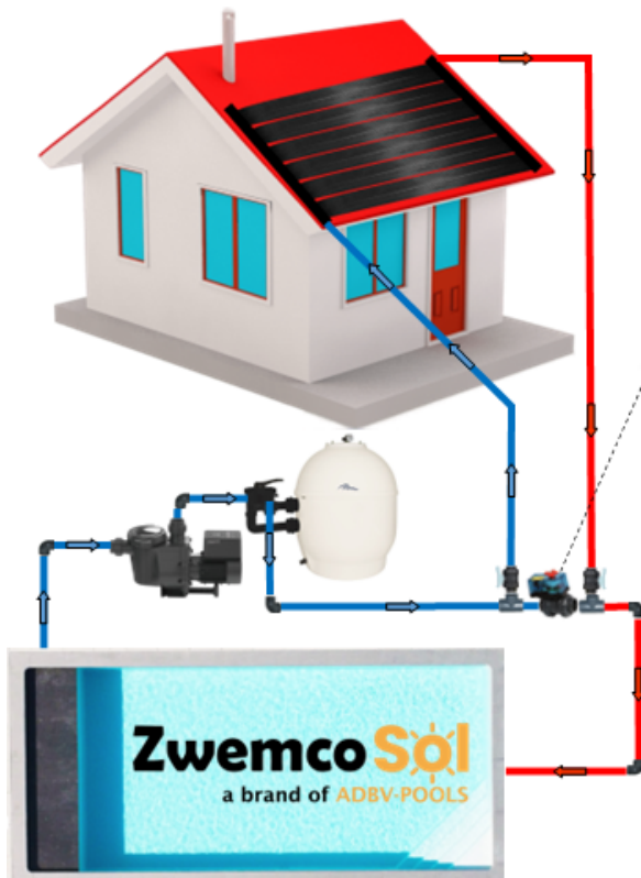
Werking op filterinstallatie
